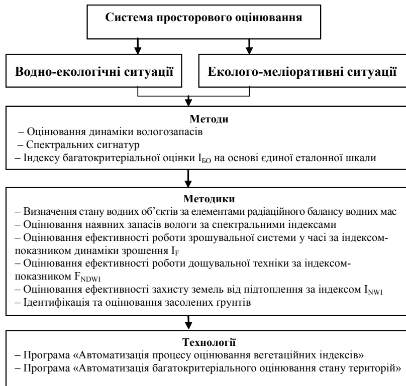
Рис. 1. Алгоритм удосконалення системи просторового оцінювання водно-екологічних та еколого-меліоративних ситуацій з використанням супутникових даних
